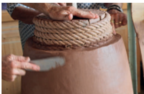
Lissage des plaques, avec un outil appelé «estèque».
