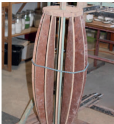
Mise en place de la structure, du socle et des ailettes destinées à recevoir la corde.
